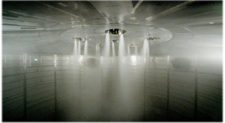
Koyulaştırılmış sütün kurutma hücrelerine atomize (pülverize) edilmesi
