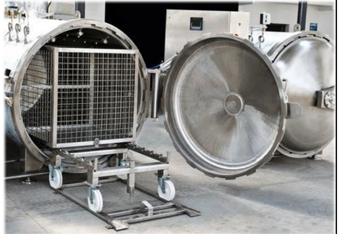
Kondanse sütün sterilizasyonunda kullanılan Otoklav
