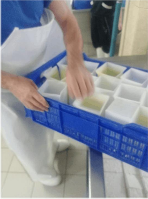
Tuzlanması tamamlanmış peynirin olgunlaşması (asitliğin ilerlemesi) için kalıplara yerleştirilmesi
