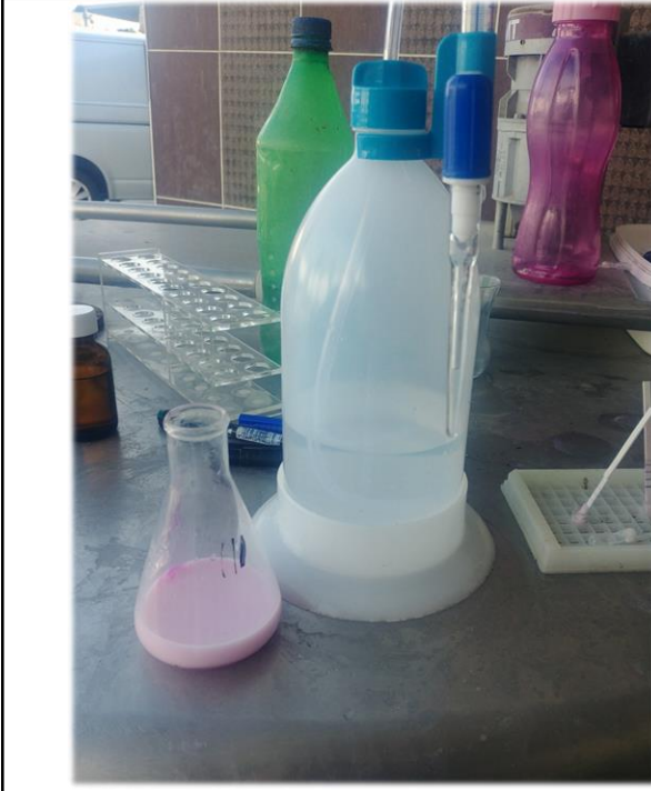
Titrasyon asitliğinin tespiti ( ^{\circ}\text{SH} )
