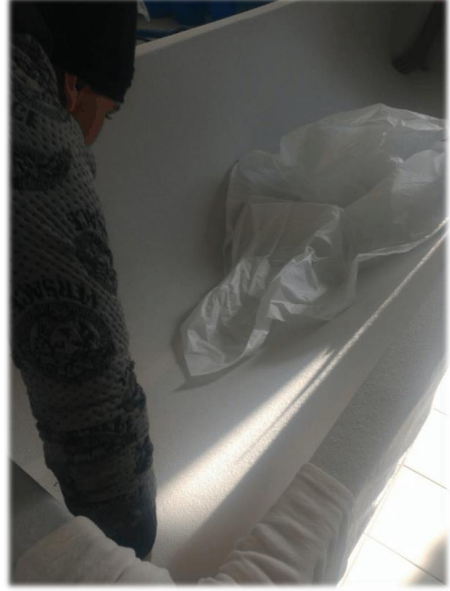
Beyaz Peynir Teknelerinin üretime hazırlanması 1. Cendere bezinin serilmesi 2. Brandanın serilmesi
