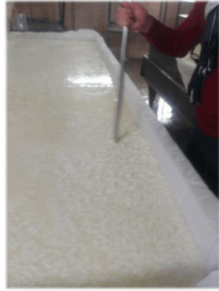
Pıhtı kırma işleminden sonra pıhtının karıştırılması ile boyutunun küçültülmesi ve sineresizin hızlandırılması
