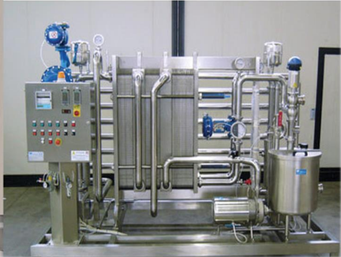
Pastörizatör (şekildeki ısı dereceleri Fahrenayt'tır)
