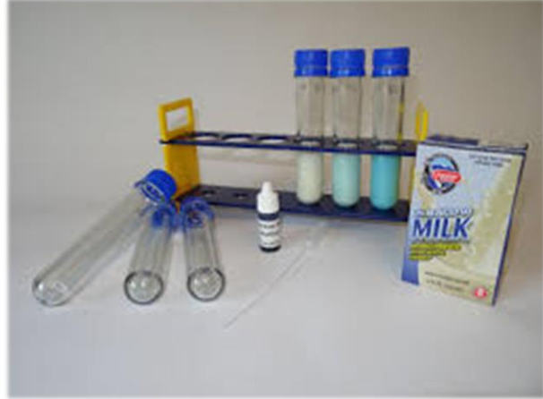
Mikroorganizma yükünün tespiti için kullanılan metilen mavisi testi
