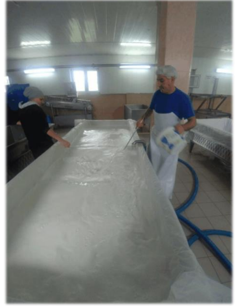
Kalsiyum klorürün süte katılıp karıştırılması
