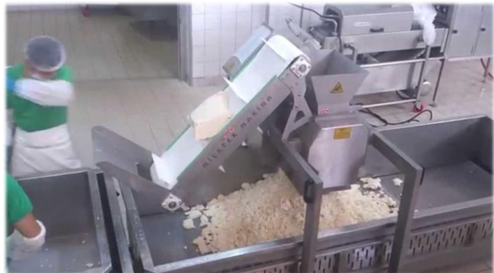
Telemenin haşlama öncesi yüzey alanının arttırılması (teleme rendeleme)
