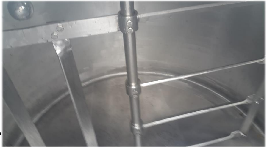
Ayran proses tankı pıhtı kırma düzeni
