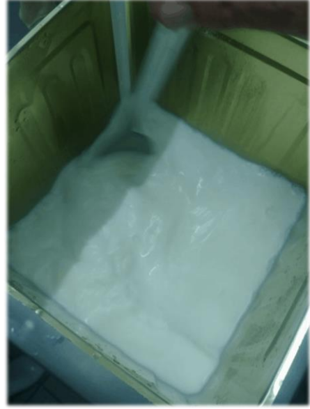
Kültürün pastörize edilmiş ve kültür çalışma sıcaklığına soğutulmuş süte karıştırılması
