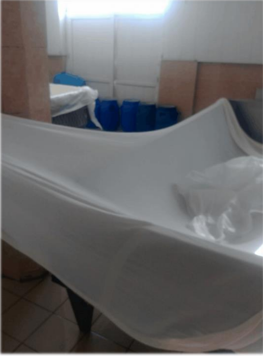
Beyaz Peynir Teknelerinin üretime hazırlanması 1. Cendere bezinin serilmesi 2. Brandanın serilmesi
