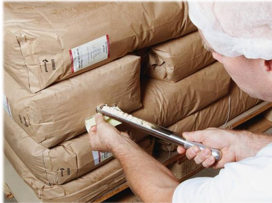
Süttozu sondası ile numune alınması
