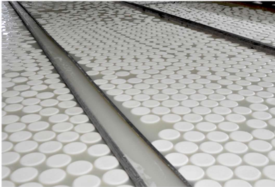
Salamura havuzlarında tam yağlı peynirin tuzlanması
