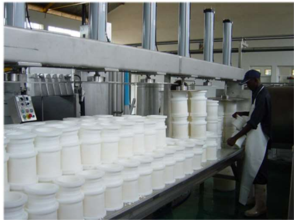
Pnömatik olarak çalıştırılan pres plakalarına sahip dikey presleme ünitesi
