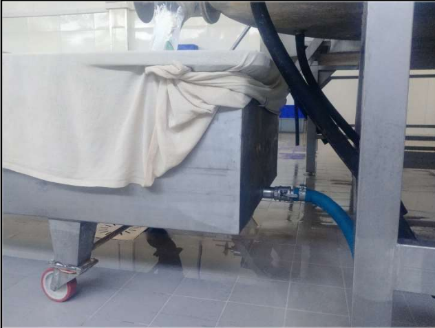
Teleme ve peynir suyunun seperasyonu
