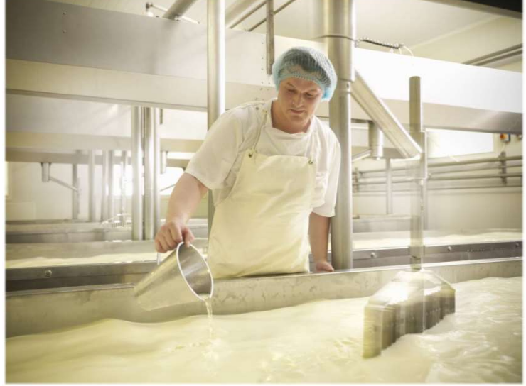
Sulandırılmış peynir mayasının süte eklenmesi
