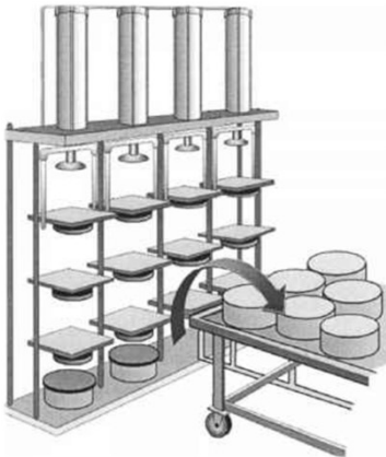
Pnömatik olarak çalıştırılan pres plakalarına sahip dikey presleme ünitesi
