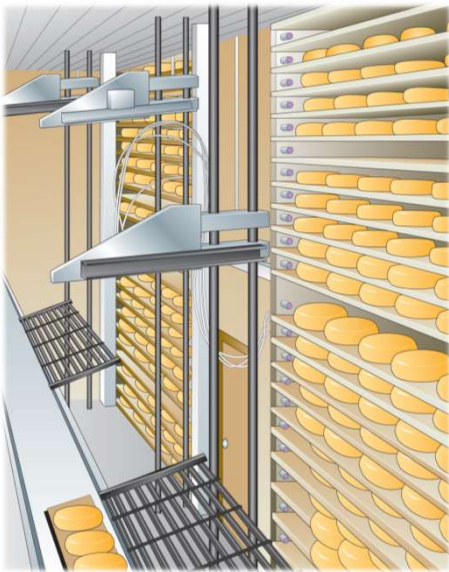
Mekanize peynir depolama. Nemlendirilmiş hava, her peynir tabakasındaki plastik nozullardan üflenir.
