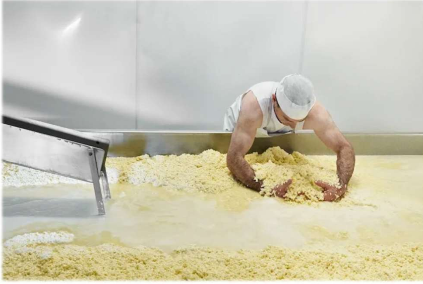
Pıhtıların boşaltılması – Pıhtı küçük granüller halinde kırılır, ardından tekneden süzülmesine izin verilerek peynir altı suyu pıhtılardan çıkarılır. Peynir altı suyunun çoğu gittiğinde, pıhtılar teknenin her iki tarafına tırmıklanarak peynir suyunun iki yığının ortasından aşağı akmasına izin verilir.
