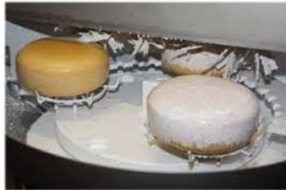
Peynir yüzeyinin parafinlenmesi
