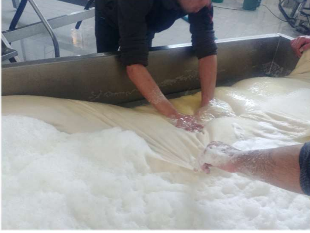
Teleme ve peynir suyunun seperasyonu
