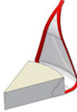
Plastik şerit kullanılmış folyo kapak
