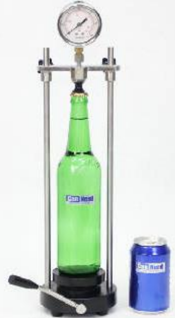
İç basınç dayanım testi
