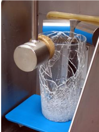
Cam darbe dayanımı testi
