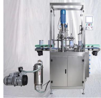
Azot gazı eşliğinde dolum yapan süttozu ambalajlama makinası
