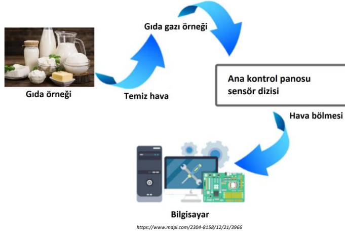
Gaz sensörü tabanlı bir gıda gazı algılama sisteminin akış şeması
