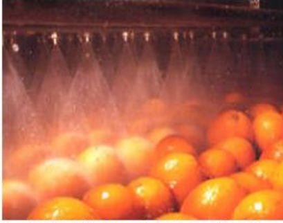
Resim 1.14: Basınçlı duşlama sistemi
