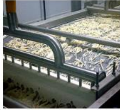
Resim 3.10: Fazla yağın sarsak eleklerle alınması gerçekleşen patatesler
