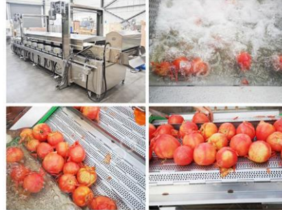
Resim 5.6: Daldırma yöntemiyle kabuk soyma
