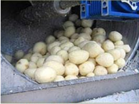
Resim 5.8: Törpüleme ile kabuk soyma makinesi
