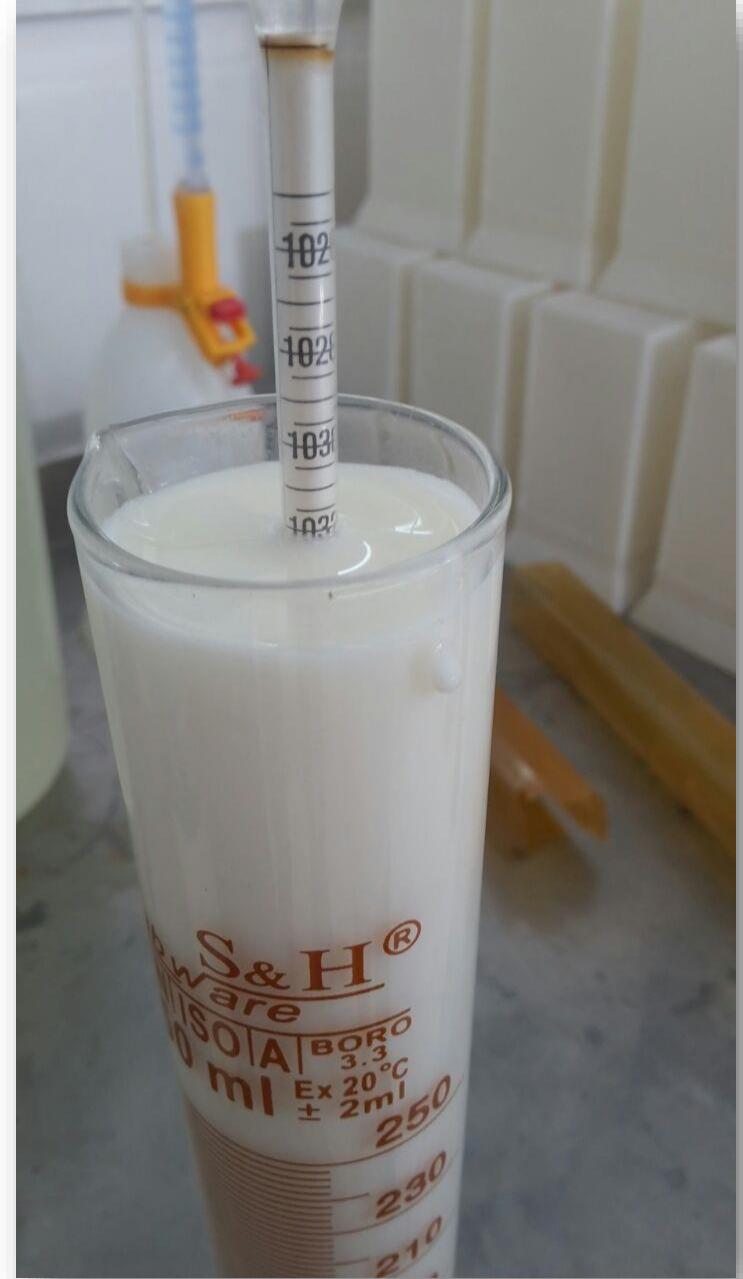
Laktodansimetre ile sütte yoğunluk ölçümü
