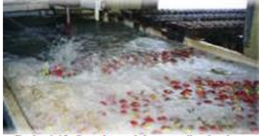
Resim 1.12: Suyu basınçlı hava verilerek yıkama
