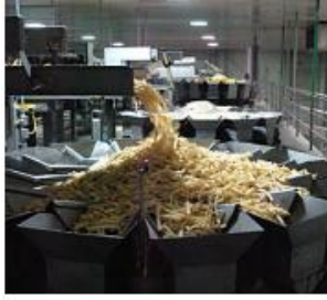
Resim 3.13: Ambalaj makinesi haznesine boşaltma
