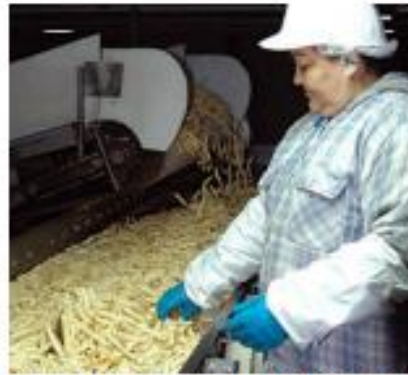
Resim 3.12: Patateslerin IQF'den çıkışı
