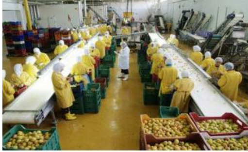
Resim 4.1: Elle kayısı çekirdeği çıkarma hattı
